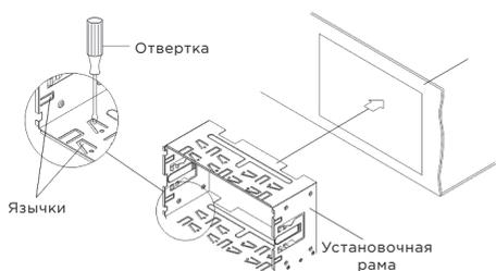
4. Вставьте установочную раму в отсек приборной панели, отогните “язычки”, расположенные по её периметру спереди и подходящие под размер приборной панели. Убедитесь в надежности закрепления рамы.
