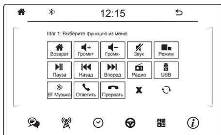
Коснитесь иконки с обозначением функции системы, который Вы хотите управлять кнопкой на руле. На экране появится надпись ШАГ 2, а выбранная иконка будет мигать. Нажмите и удерживайте в нажатом положении в течение 2-х секунд кнопку на руле, которой Вы хотите включать выбранную функцию системы. На экране появится надпись ШАГ 3 (Соответствие установлено). Аналогичные операции проведите для других кнопок.
