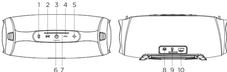
1. ☰ - Кнопка включения/выключения режима Bluetooth (длительное нажатие)
