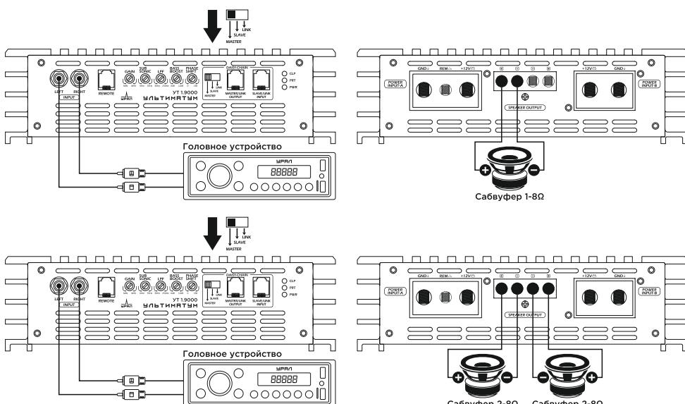
С головного устройства подаются сигналы двух каналов. К усилителю могут быть подключены один сабвуфер с импедансом 1-8 Ом или два сабвуфера с импедансом 2-8 Ом. Переключатель режимов установлен в положение MASTER.
