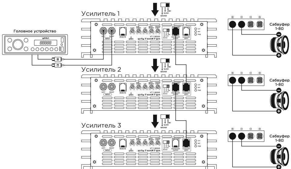
С головного устройства подаются сигналы двух каналов. К усилителям могут быть подключены сабвуферы с импедансом 1-8 Ом. Переключатели режимов установлены в положение MASTER.
