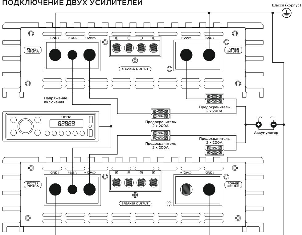
Входы подключаются к линейным выходам головного устройства. Для уменьшения внешних помех подключения к входам рекомендуется проводить кабелями RCA с двойным или тройным экраном. Кабели RCA должны быть максимально удалены от проводов питания (например, можно провода питания проложить с правой стороны салона автомобиля, RCA кабели - с левой стороны).
