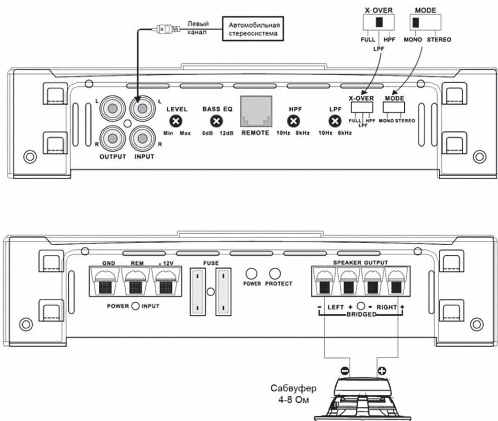
С автомобильной стереосистемы подаются сигналы одного (левого) канала. Положение переключателей показано для случая использования сабвуфера в режиме повышенной выходной мощности (мостовой режим), в монорежиме (переключатель MODE в положении MONO) с включением фильтра нижних частот (переключатель X-OVER в положении LPF).
