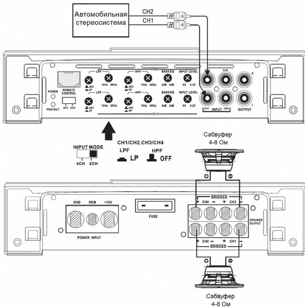
С автомобильной стереосистемы подаются сигналы двух каналов.
