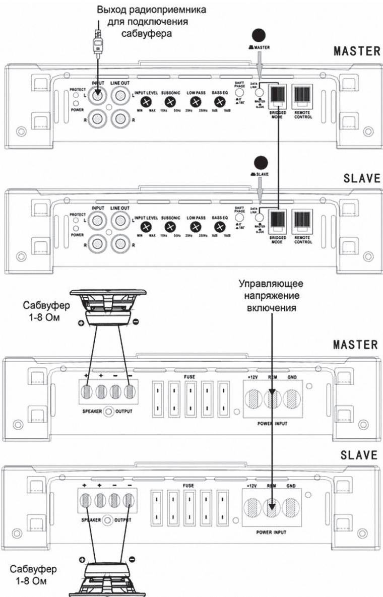
Подключение двух усилителей позволяет увеличить выходную мощность. Основной усилитель (Master) управляет работой дополнительного усилителя (Slave).
