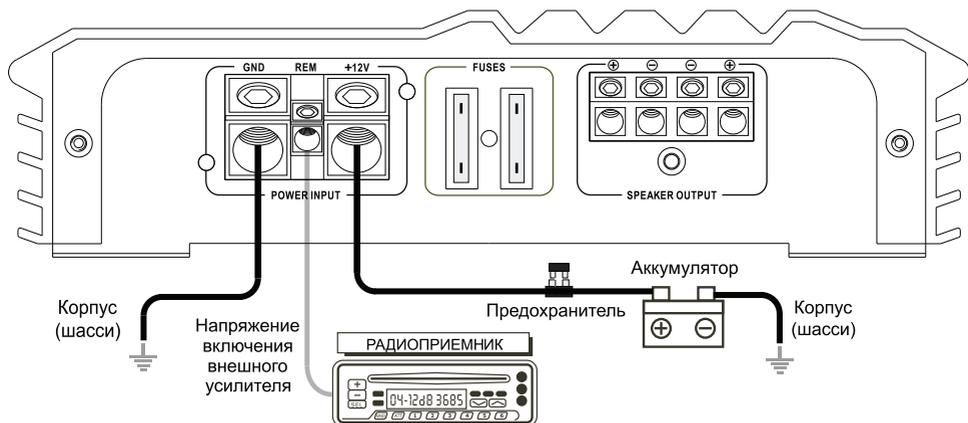
Входы усилителя подключаются к линейным выходам головного устройства. Подключения рекомендуется проводить кабелями RCA с двойным или тройным экраном. Для исключения помех кабели RCA должны быть максимально удалены от проводов питания (например, можно провода питания проложить с правой стороны салона автомобиля, аудио кабели – с левой стороны).
