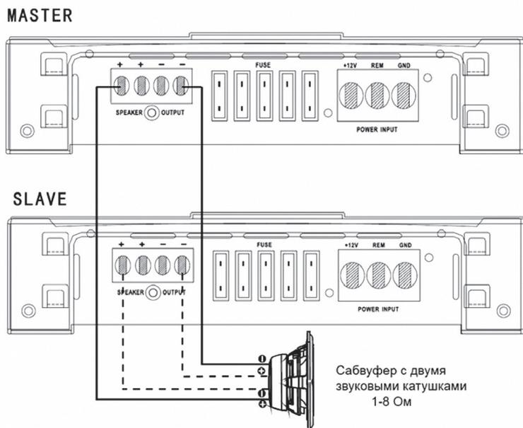
Звуковые катушки сабвуфера подключаются к усилителям противофазно (как показано на рисунке).
