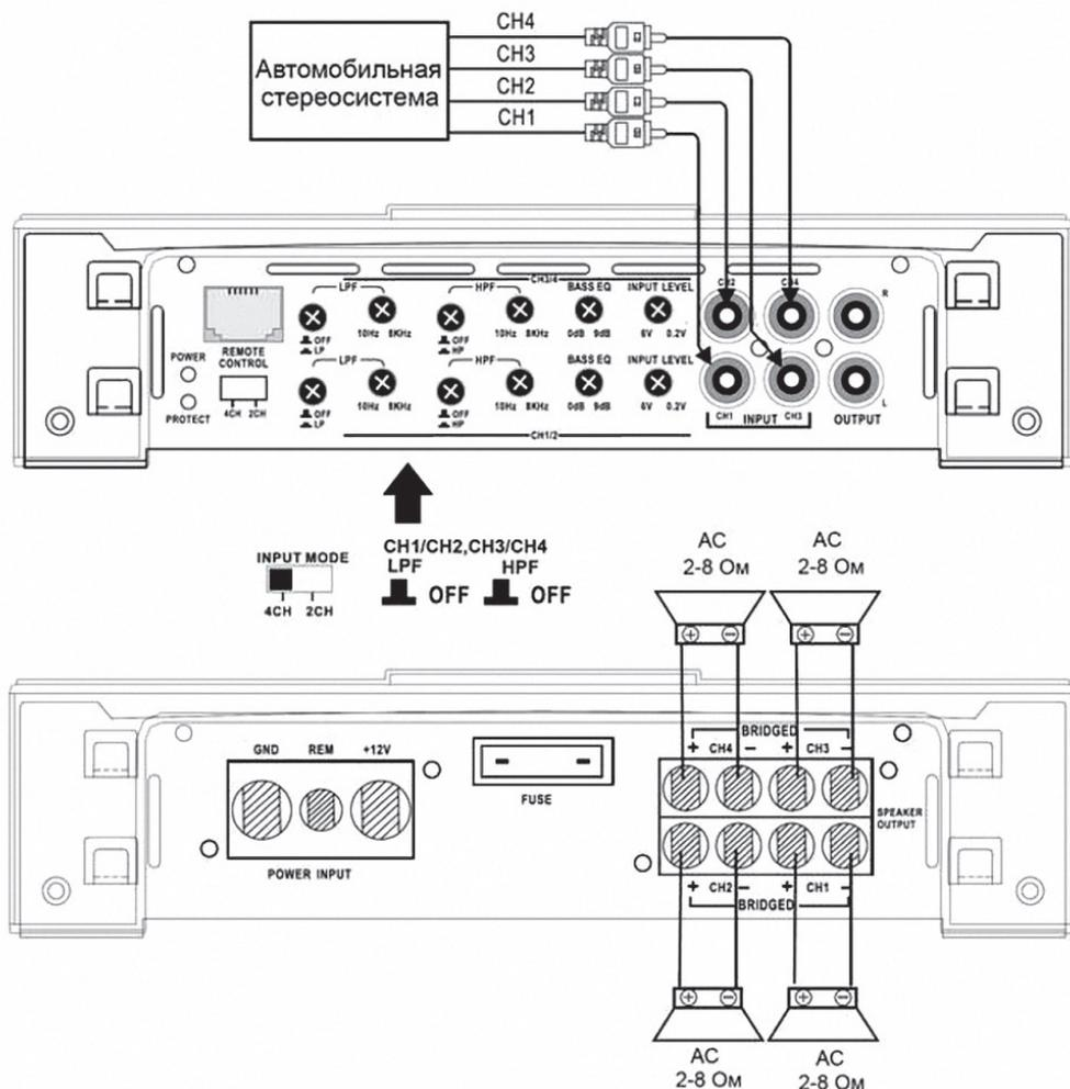
С автомобильной стереосистемы подаются сигналы четырех каналов. Все AC широкополосные. Во всех каналах фильтры верхних и нижних частот выключены (кнопки LPF, HPF не нажаты), что соответствует линейной частотной характеристике усилителя.
