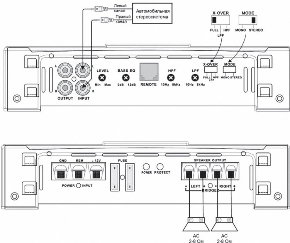
С автомобильной стереосистемы подаются сигналы двух каналов. Положение переключателей показано для случая использования широкополосных АС (переключатель **X-OVER** в положении FULL) в стереорежиме (переключатель **MODE** в положении STEREO).
