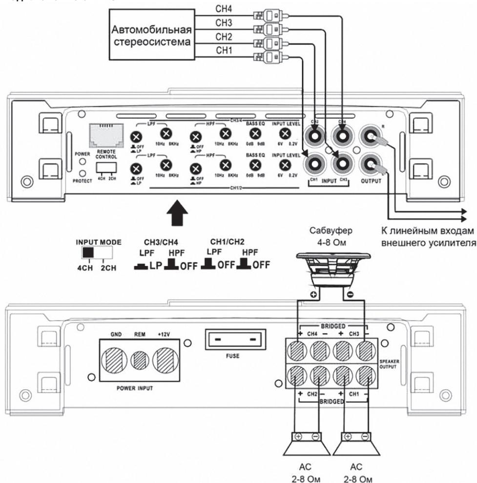
С автомобильной стереосистемы подаются сигналы четырех каналов. К каналам CH1, CH2 подключены широкополосные АС. К каналам CH3/4 подключен сабвуфер в режиме повышенной мощности (мостовой режим). В каналах CH1/2 фильтры верхних и нижних частот выключены (кнопки LPF, HPF не нажаты), что соответствует линейной частотной характеристике усилителя. В каналах CH3/4 включены фильтры нижних частот (кнопка LPF нажата) и выключены фильтры верхних частот (кнопка HPF не нажата).
